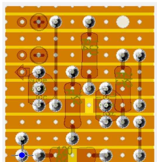
Achtung: Lochmaster klappt über die untere Kante. + ist die 5V-Zuführung.
