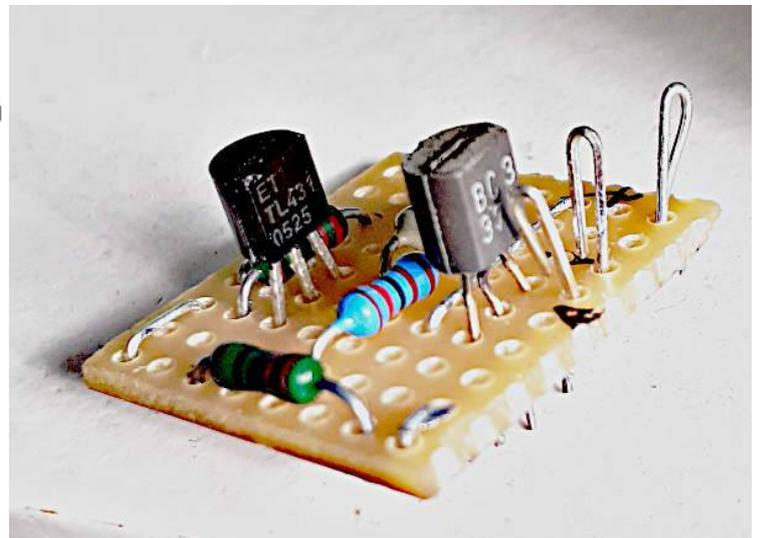
R2 mit 1k32 führt zu gerechneten 3,99 V am Ausgang. Der Widerstand wird als Reihenschaltung 1k2 + 120R ausgeführt.
